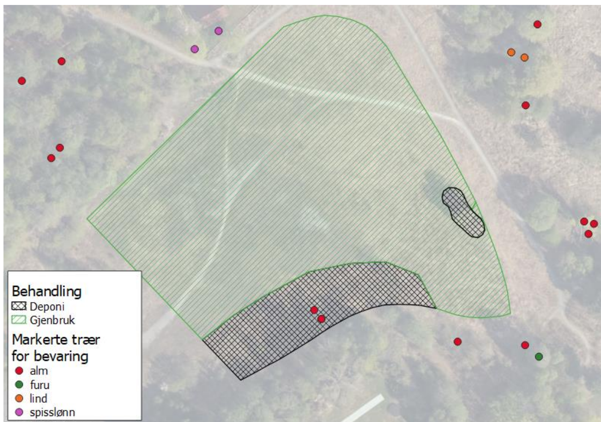
Figur 8: Kartet illustrerer de delene av B3 hvor masser kan gjenbrukes eller må deponeres. Svart skravur er masser som graves opp, pakkes, og sendes til deponi, mens grønn skravur er masser som kan gjenbrukes og mellomlagres i fF2 før gjenbruk. De røde prikkene er to almetrær som skal bevares, og disse er markert i felt med rødt bånd. Almetrærne må graves opp før man graver opp resten for deponering.
