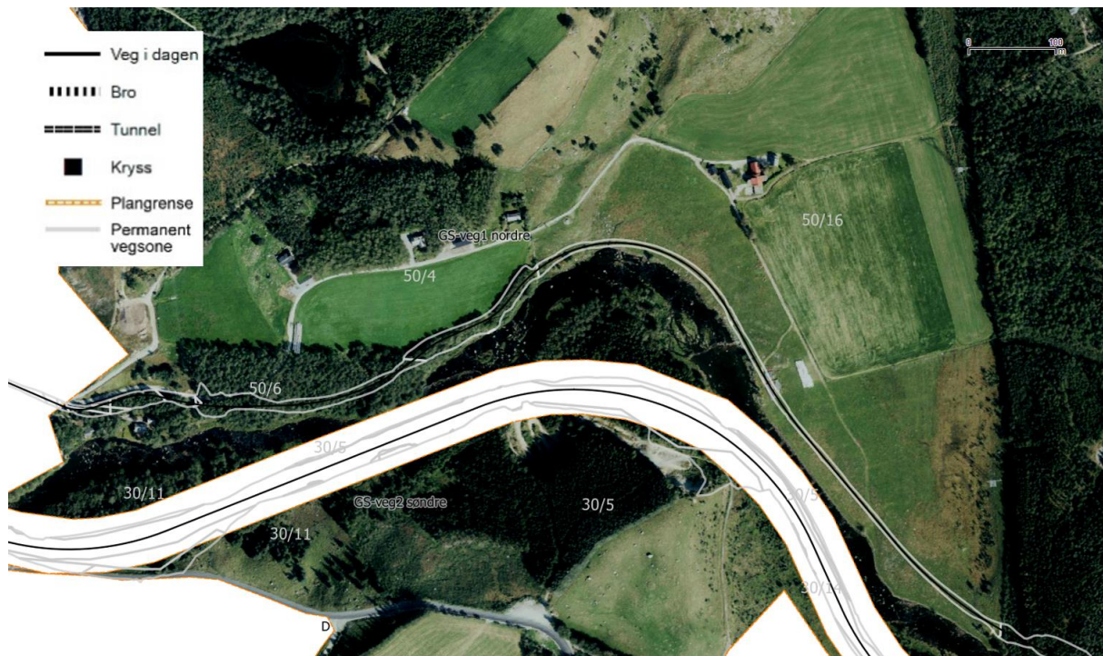
Figur 5.10: Ved Eikelandsmyrane går GS (nordre) langs innmarksbeite på eiendom 50/16, og beslaglegger areal ned mot elvekanten. GS (søndre) går eksisterende jernbanespor med byggelinje (regulert stripe i hvit).
