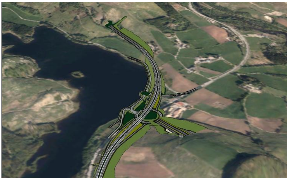
Figur 1.7: Tverrforbindelsen kobles til E39 i planskilt kryss på Bråstein.
