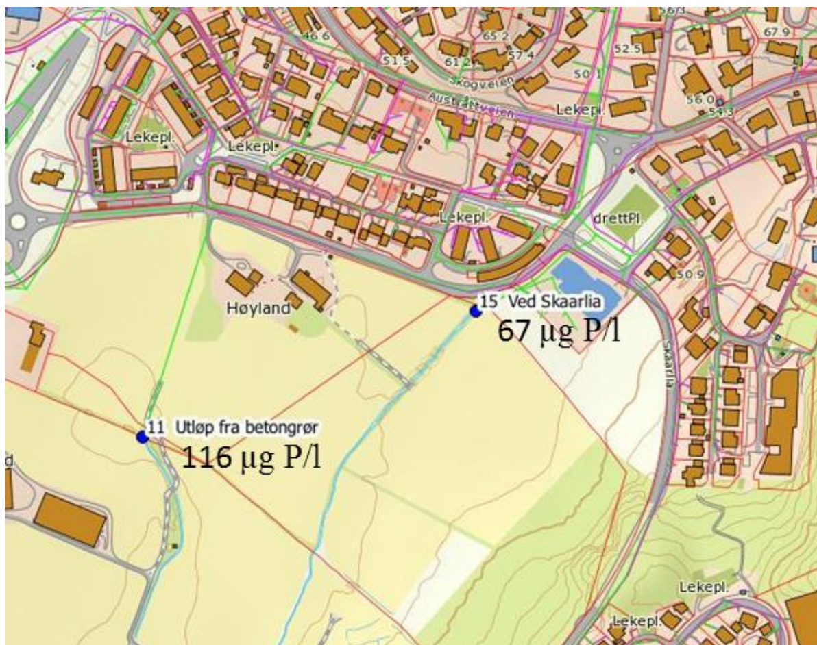
Figur 8.1. Prøvetakingsstasjoner i øvre del av Svebestadfeltet. Figuren viser også overvannsledninger som (grønne strek) som leder fram mot prøvetakingsstasjonene. Gjennomsnittlig fosforkonsentrasjon for prøver (over 60 st.) i perioden 2011-2016 er også vist.
