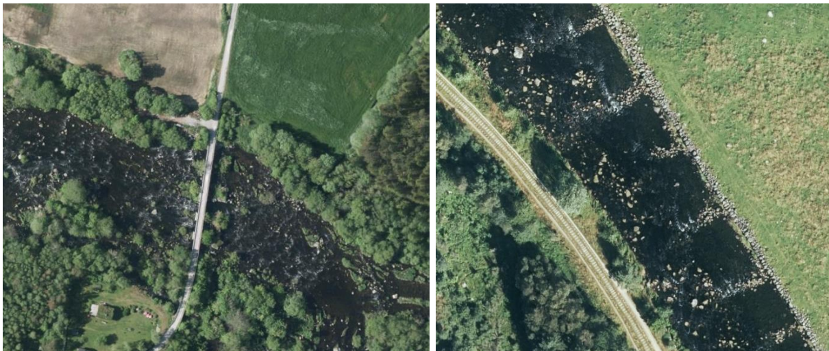
Figur 11. Eksempler på elveløp med stor variasjon. Til venstre fra Bråstein med naturlig steinsetting og stor variasjon. Til høyre viser et strekk langs Eikelandsmyrene hvor vestre del av elva har naturlig, spredte steiner. I østre del av løpet er steinene ryddet i buner. Kilde: Norge i bilder, 2015.
