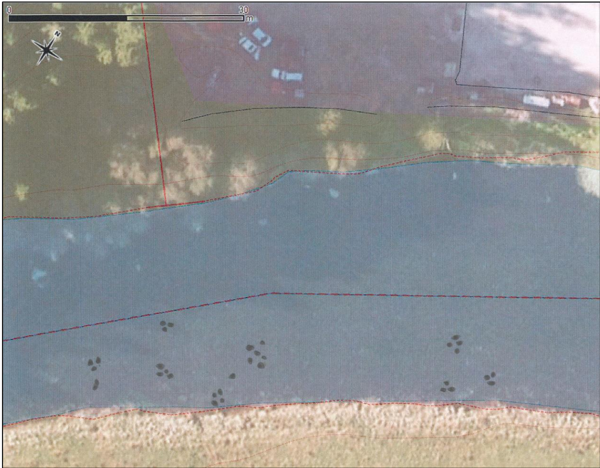
Figur 22. Skjematisk skisse av tiltak 13: Utlegg av klynger med stein og blokk i sørlige del av løpet, da det er mye elvemusling på nordsiden.
