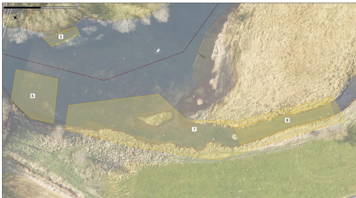
Figur 26. Området innenfor tiltaksområde 7 bør harves før steinutlegging da det preges av tilslamming, og tiltak som øker vanngjennomstrømming i sideløp vil øke og dermed endre sedimenteringsprosessen i sonen.
