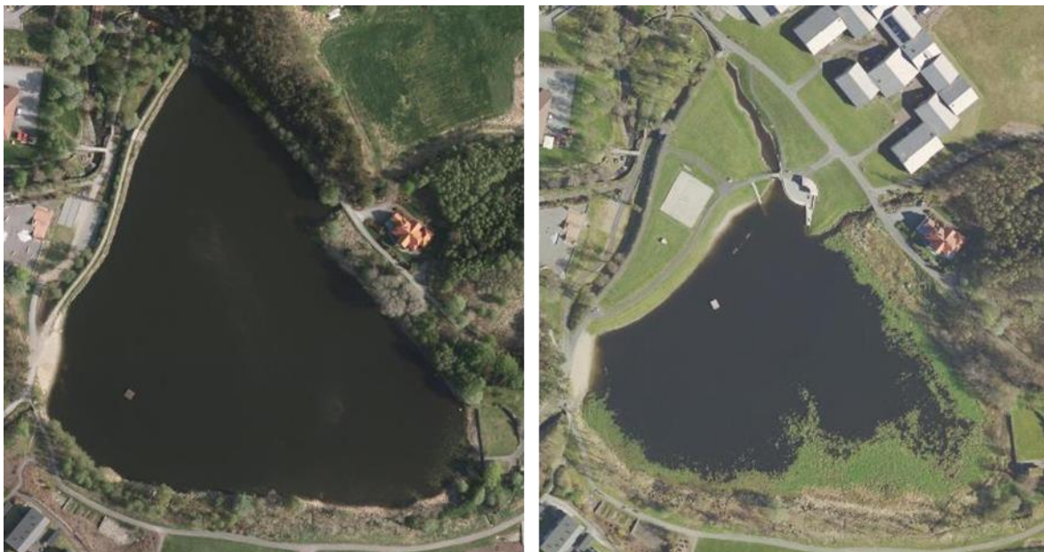
Figur 1.1. Stemmen før (t.v) og etter (t.h) senkning og opparbeidelse av parkarealer og badeplass.
