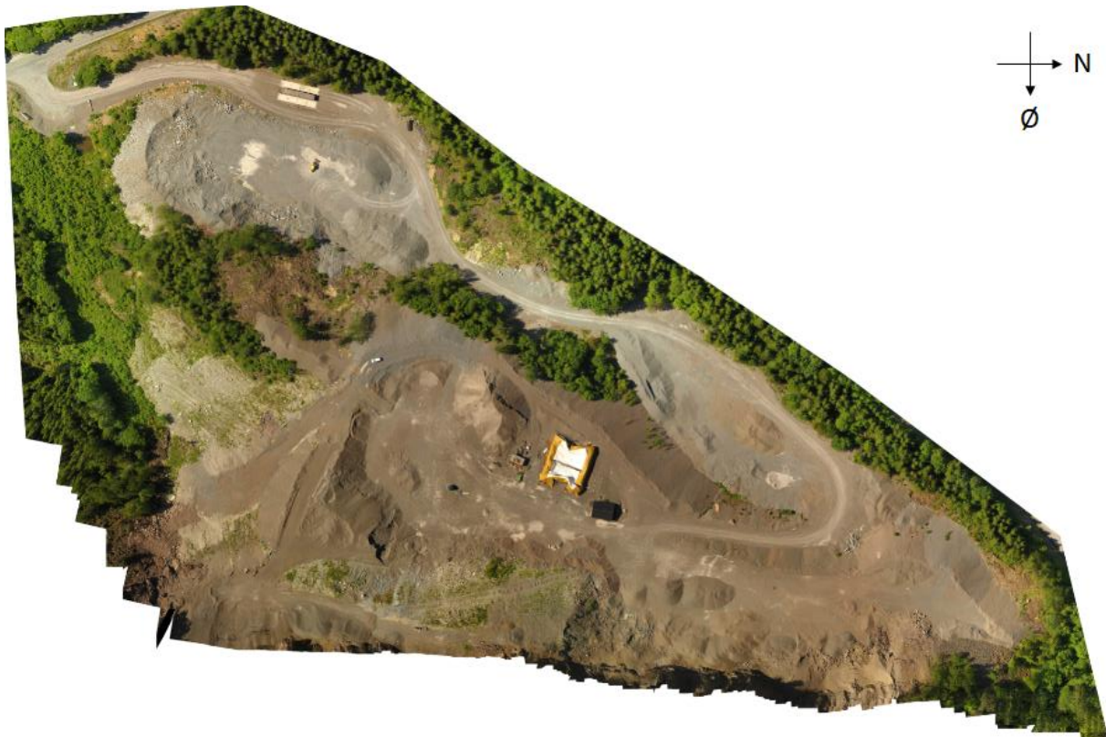
Figur 3.1. Dronefoto av Toverud Pukk og Deponi som viser omfattende terrenginngrep, hvor området mellom bergvegg i øst og anleggsvei i vest er tilnærmet blottlagt.
