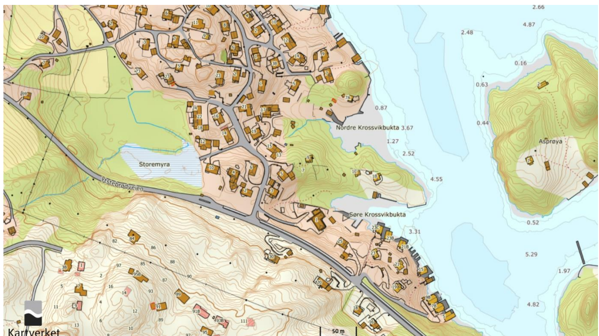
Figur 2. Ytstebrødveien ble utvidet i nordlig retning hvor Storamyra er lokalisert. Nedbørsfeltet til myra inkluderer vann fra høydedragene i sørvest. Fra Storemyra går vannet i rør og åpen kanal ned til Nordre Krossvikbukta.
