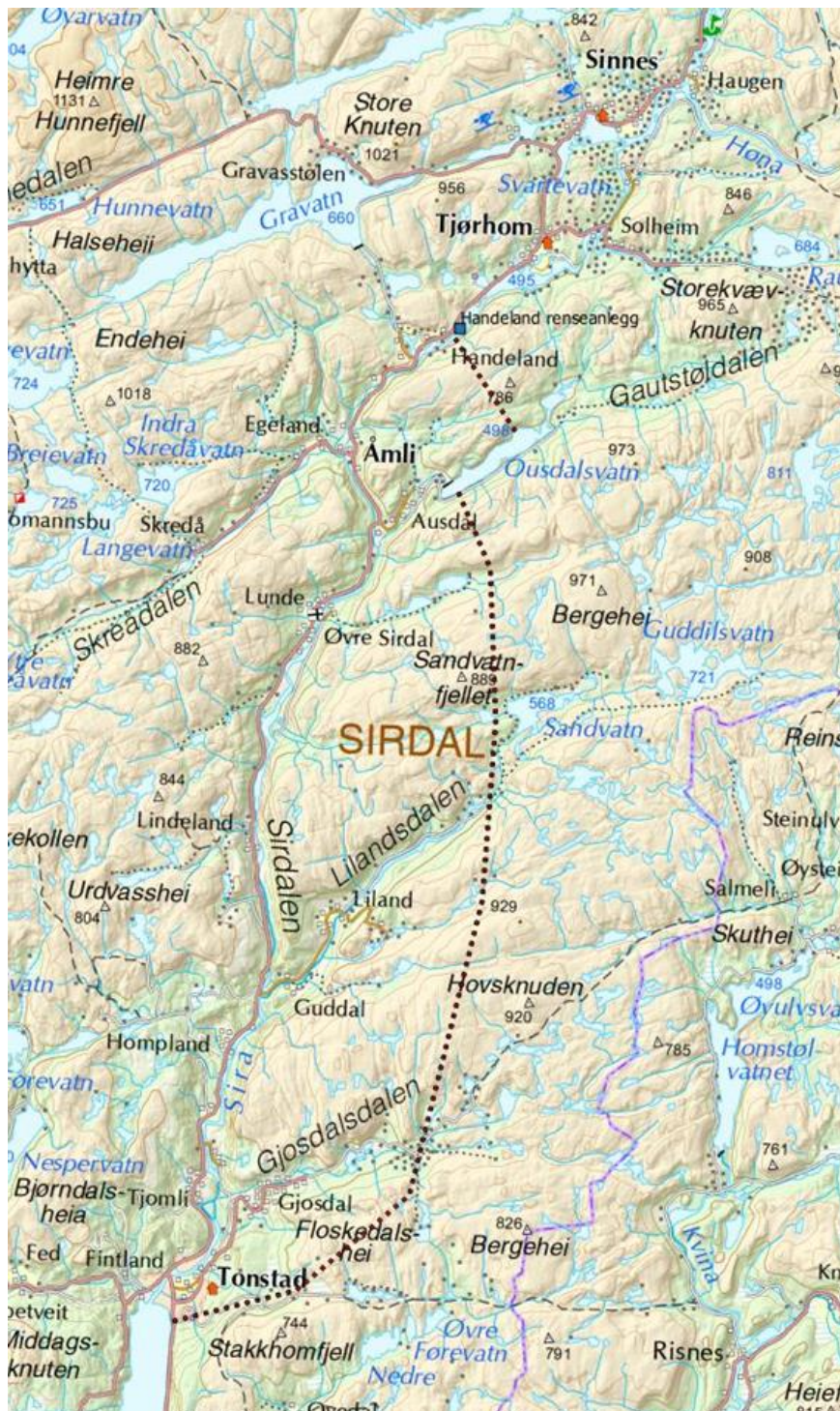
Figur 1.1. Oversiktskart som viser beliggenheten av Handeland renseanlegg og vannveier (overføringstunneler fra Tjørhomvatnet via Ousdalsvatnet til Sirdalsvatnet).
