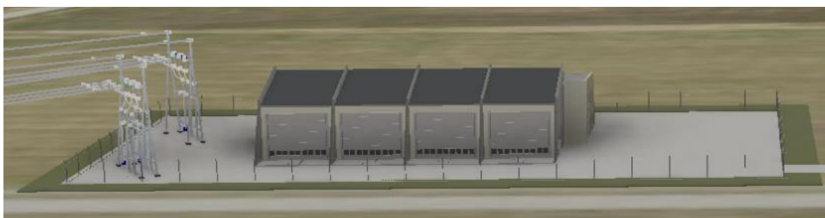
Figur 3.3. Prinsippskisse av kapslet, gassisolert (GIS) transformatorstasjon.
