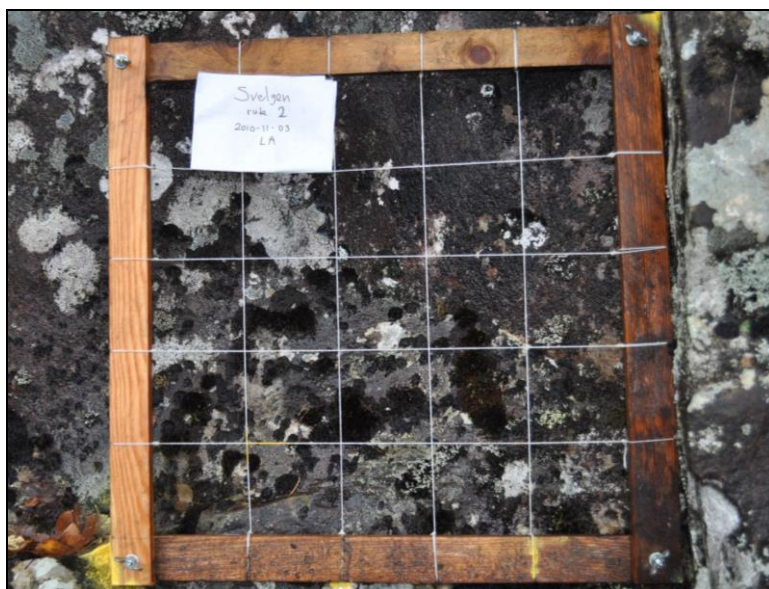
Figur 2.14. Analyserte 2 ved Svelgen i 2010. Rammen ble lagt så at nedre kanten har støtte fra en liten hylle i berget. Merk gul fargemarkering.
