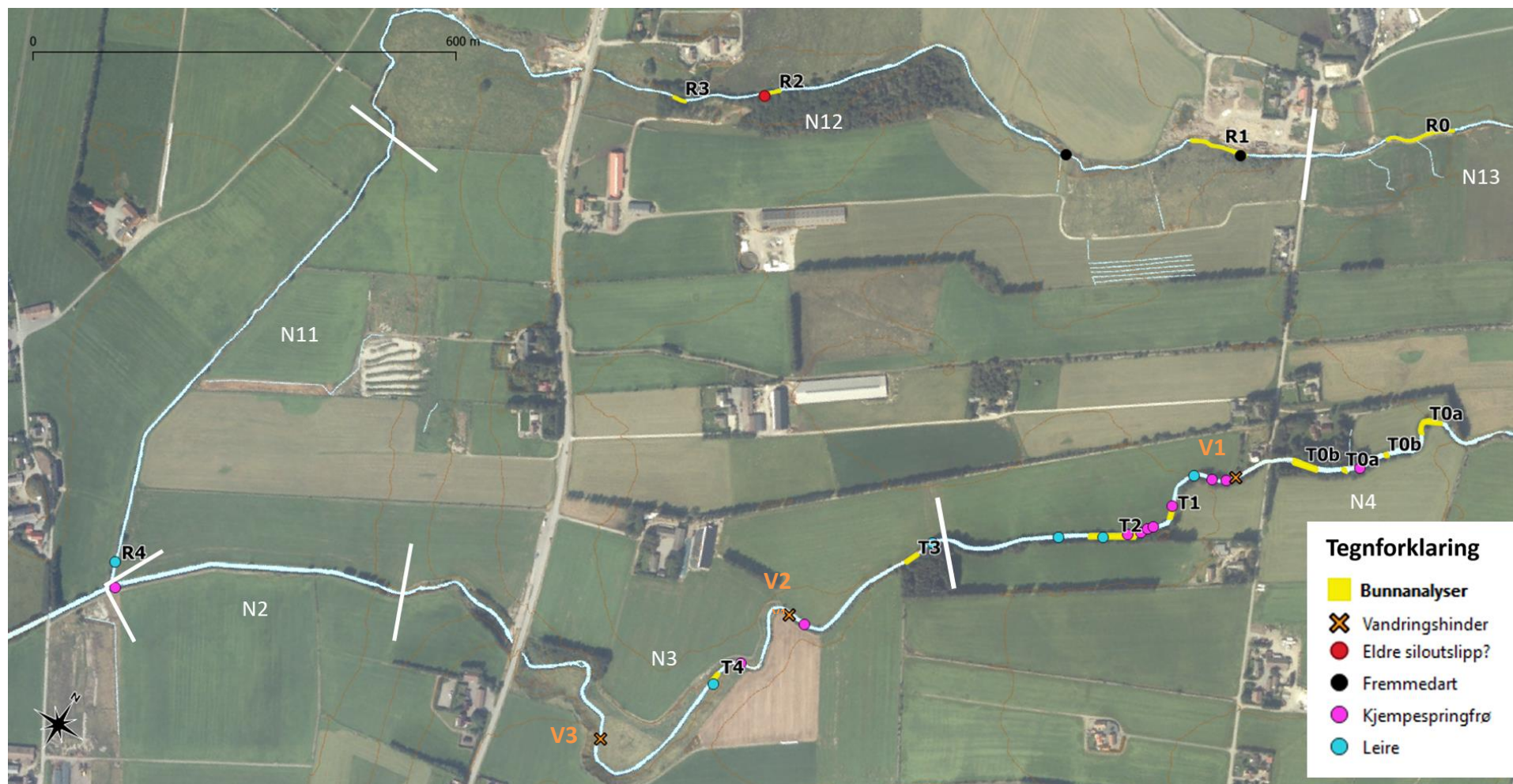
Figur 4-1. Bunnanalyse (kornfordeling og skjul) ble utført på 5 stasjoner i Rongjåbekken (R0-R4) og 6 stasjoner i Tvihaugbekken (T0a-T4) i juni 2023. For å kunne sammenligne resultatene med skjulforhold som ble habitatkartlagt i 2018 er disse segmentene (N2-N4 og N11-N13) markert i hvitt.
